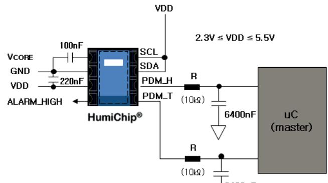
Figure 2.2: Typische Anwendungsschaltung (PDM)
